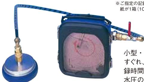
小型・軽量で携帯性にすぐれ、長短5段階の記録時間切替機能を持ち、水圧の経時変化の記録を行います。
