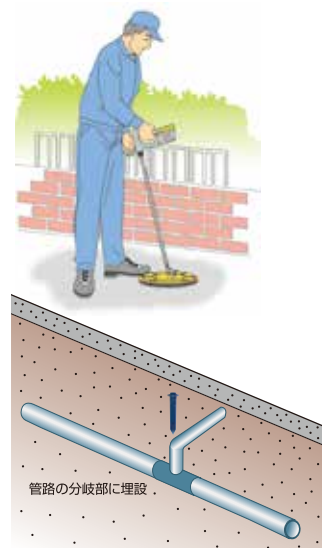
管路の探査例
