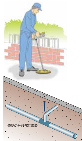
管路の探査例
